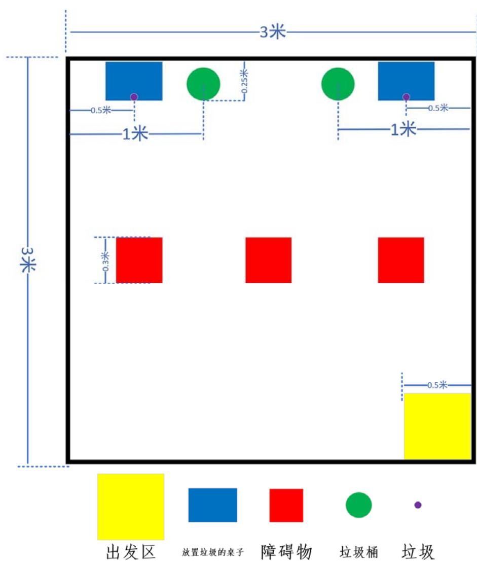
1) 比赛场地为 3m\*3m 的正方形场地，赛场将使用隔离板隔离，隔离板高度为 0.4m。场地地面及隔离板颜色为白色，出发区的尺寸
