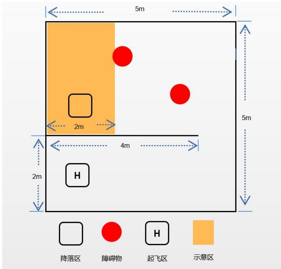
1) 比赛场地尺寸为长 5 米、宽 5 米、高 2.5 米，场地四周设置有高为 1.2 米的围挡，场地中间使用移动隔板做隔断，隔板高度 1.2 米。四周及顶部布置有防护网。
